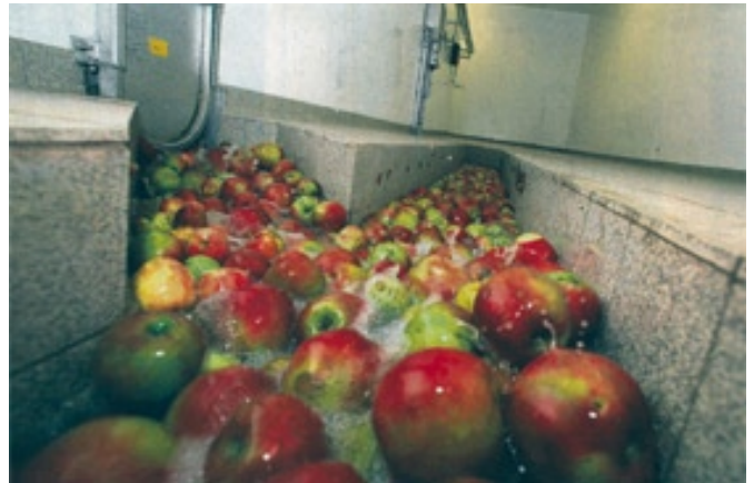
Am Anfang sind die Äpfel: In der taufriischen Anlage werden sie mit Wasser zur Presse geschwemmt und dabei gleichzeitig gewaschen.
